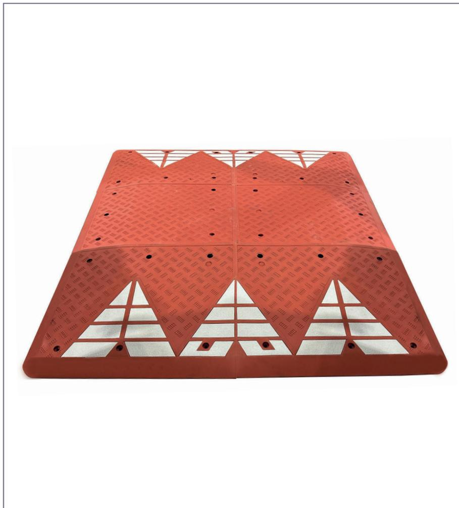
**Cojín berlinés** prefabricado de caucho para vías urbanas. El cojín es una elevación implantada en medio de la calzada que constituye un obstáculo en función de la distancia de las ruedas del mismo eje del vehículo que permite a los autobuses y otros vehículos pesados no verse afectados por la misma, ya que la separación entre ruedas es más ancha que la altura del cojín berlinés.
