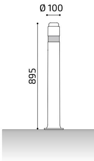
**Pilona semiflexible luminosa A-Eco con leds solar** en la parte superior que se activa automáticamente al oscurecer, led de luz perimetral en color blanco. Posibilidad de luz fija o intermitente según el modelo a elegir.
