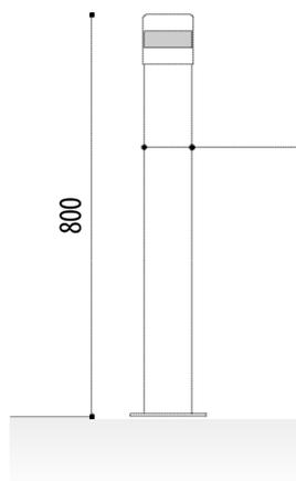
**Pilona luminosa modelo Urban con leds 2** de bajo consumo. Construida con tubo de hierro lacado al horno, con parte superior de acero inoxidable.
