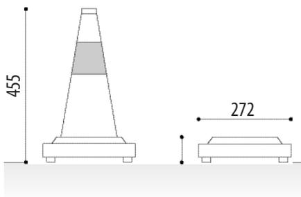
Cono vial de señalización plegable modelo **Moncayo** de 272x455 mm. de tela reflectante impermeable naranja de fácil plegado con base de caucho.
