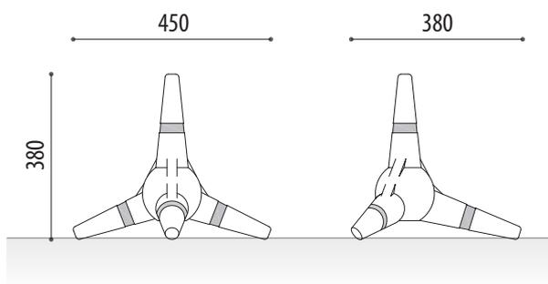
**Tetrápodo vial modelo Alpes** fabricado en plástico polietileno de gran flexibilidad, que les permite soportar grandes impactos y la degradación de los rayos solares.
